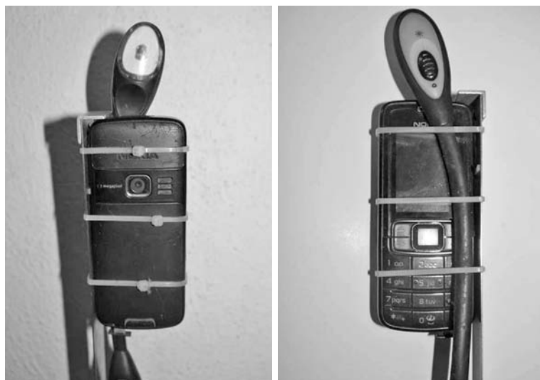
Fig. 1. Telefono cellulare utilizzato per filmare l'interno dei nidi artificiali; dettaglio del sistema di fissaggio.
